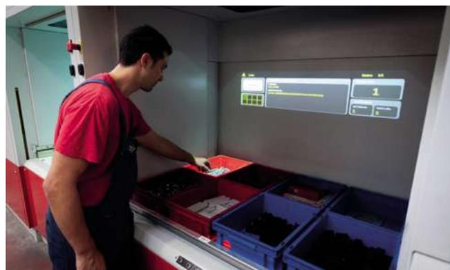
**IRIDE**, il **sistema di controllo interattivo\*** rende più intuitive, veloci ed accurate tutte le tue operazioni di prelievo e di deposito, grazie ad un ambiente digitale totalmente integrato nella macchina ed in ICON e attraverso 4 diverse funzionalità:
